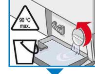
3. Осторожно отверните крышку насоса (остаточная вода!).
