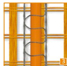
Уникальная пришивная технология крепления кабеля гарантирует фиксацию кабеля при монтаже, а также максимальную теплоотдачу.
