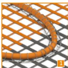
Диаметр кабеля около 4 мм позволяет использовать минимальную толщину плиточного клея.
