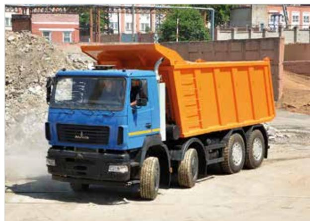
МАЗ-6516Y9-7521-000 с двигателем Cummins SG12460 Евро-5
