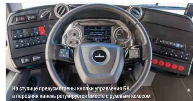
На ступице предусмотрены кнопки управления БК, а передняя панель регулируется вместе с рулевым колесом
