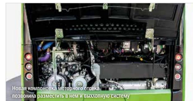
Новая компоновка моторного отсека позволила разместить в нем и выхлопную систему
