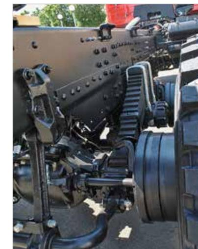
Балансирная подвеска «трехосника» – на заднем мосту предусмотрен стабилизатор
