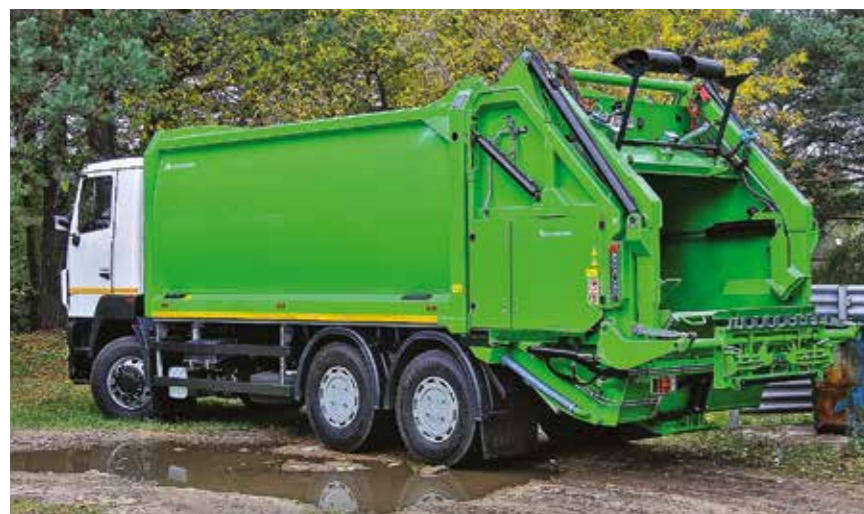
Мусоровоз MAZ 690GB5-N10 со спецнадстройкой GeesinkNorba GPM IV 22H25P. Вместимость кузова – 22 м 3 . Пол и стенки изготовлены из стали Hardox 450: пол – 5 мм, стенки – 4 мм
