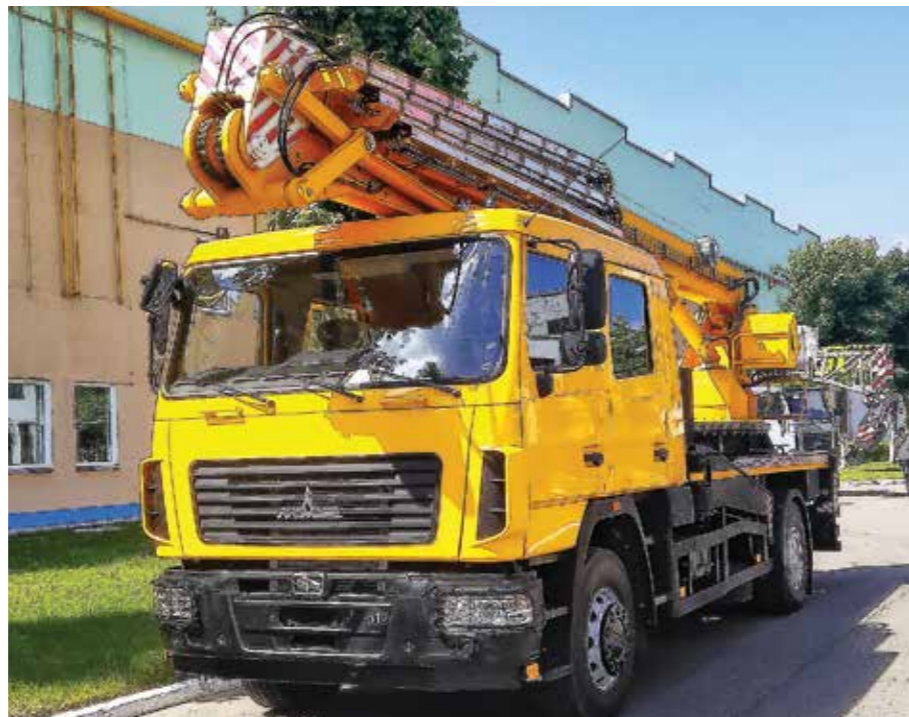
6-местная двухрядная кабина модели 437212 на АГП-30-С (база – шасси МАЗ-5340В5)
