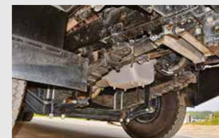
Несмотря на то, что предположительной сферой деятельности автобуса будет отсутствие нормальных дорог, от защиты двигателя было решено отказаться
