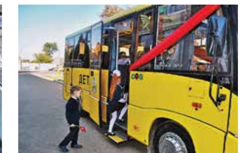
Выдвижные ступеньки для «первоклашек» – именно такие специфические «мелочи» и выделяют автобусы для перевозки детей среди обычных машин
