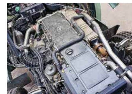
Рядная «шестерка» Mercedes-Benz OM471 – столь плотная компоновка обусловлена большим количеством вспомогательных агрегатов
