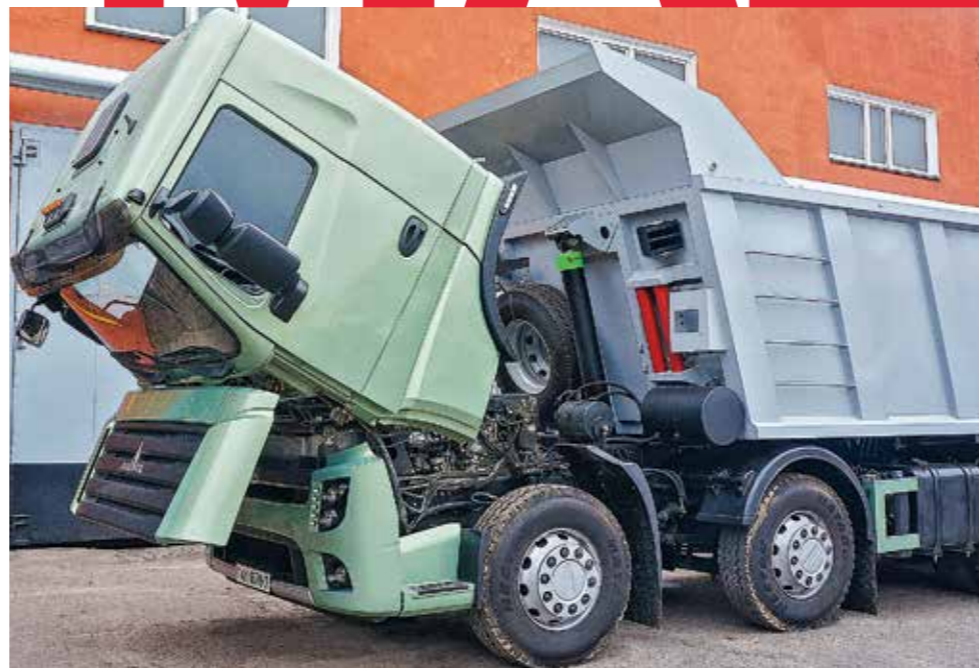
При поднятой кабине хорошо видно, что от нее до земли 550 мм
