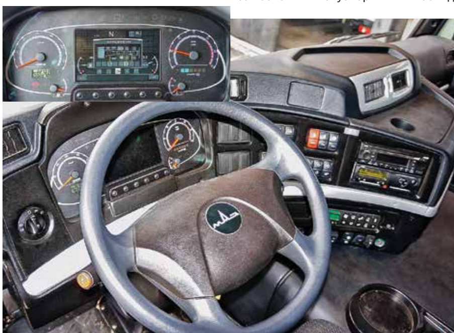
Столь роскошный интерьер самосвала обусловлен унификацией передней панели с таковой и на магистральных тягачах
