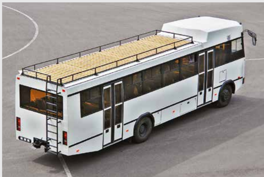
Вся крыша – большой багажник, с доступом по лестнице. Благодаря кольцевой структуре крыши его грузоподъемность достигает 3 000 кг!
