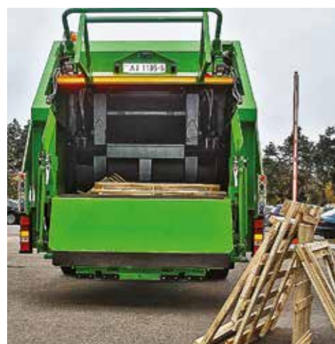
Особенность нового мусоровоза – возможность измельчать крупные предметы (поддоны, мебель) при погрузке
