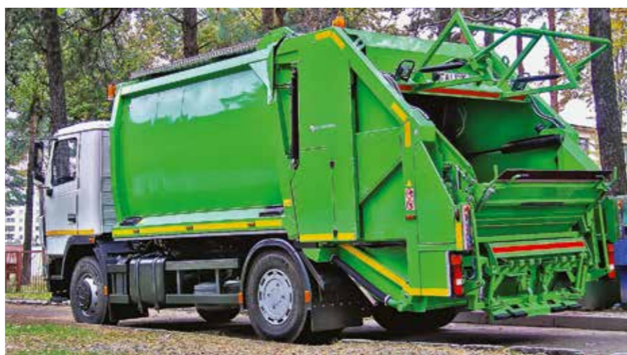
Мусоровоз MAZ 690314-N10 со спецнадстройкой GeesinkNorba GPM 15H25. Вместимость кузова – 15 м 3 . Усилие прессования – 32 т. Цикл прессования занимает 25 с.
