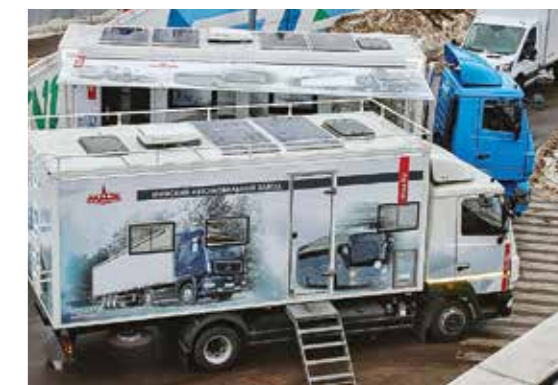
На крыше обоих автомобилей установлены солнечные батареи
