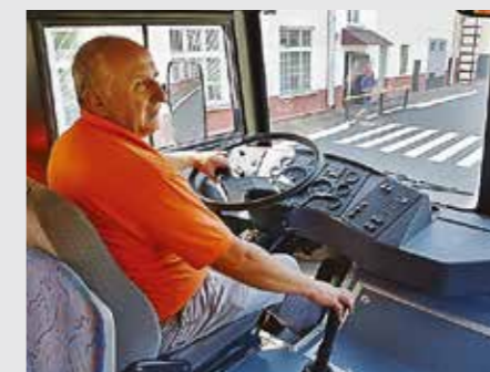
Водитель сидит на 100 мм выше, чем в стандартной кабине MAZ 5337 – для сохранения эргономики переделаны рулевая колонка и кулиса МКП
