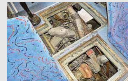
Доступ к двигателю и коробке передач из салона производится через два больших люка в «капоте», так же можно добраться и до заднего моста
