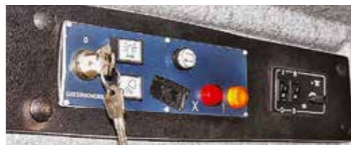
Управление установкой GeesinkNorba частично вынесено под потолок кабины и даже оснащено персональным ключом запуска
