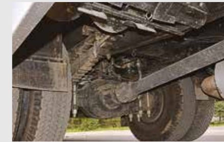
То, что автобус базируется на грузовом шасси, легко определить по многолистовым рессорам. Вместо стандартных осей здесь усиленные, от лесовозов
