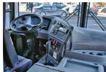
Интерьер кабины 257-го – передняя панель развернута к водителю, уменьшилась высота моторного отсека, появилась персональная дверь
