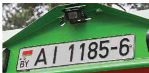
Камера заднего обзора – обязательный элемент для спецкузовов GeesinkNorba
