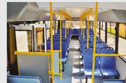
Высота салона составляет 1 980 мм практически по всей длине салона, с учетом того, что из-за рамного шасси высота пола 1 050 мм – хороший показатель
