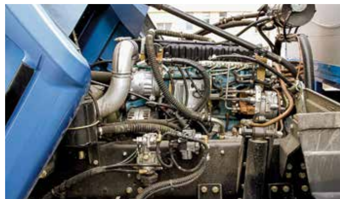
Вот он, «безмочевинный» ЯМЗ-53423 стандарта Евро-5 во всей красе под кабиной MAZ-4381C0
