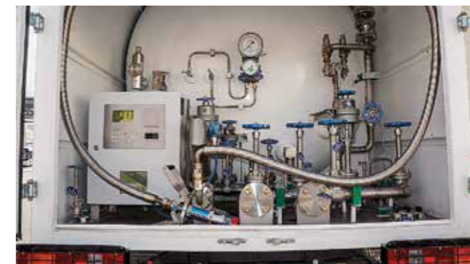
«Раздаточная колонка» представляет собой обилие вентилей и электронный блок управления
