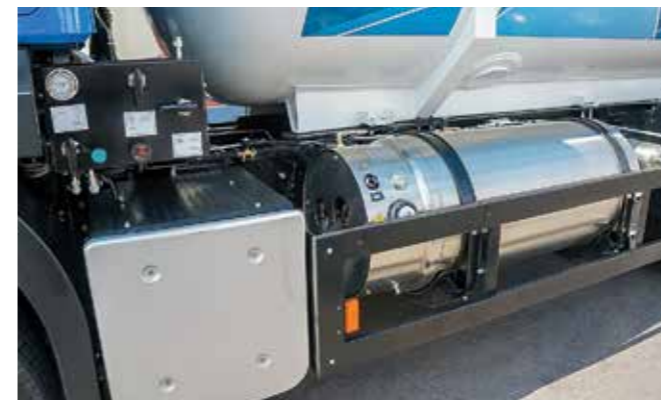
Слева – пульт управления баками, справа – криобак для сжиженного природного газа
