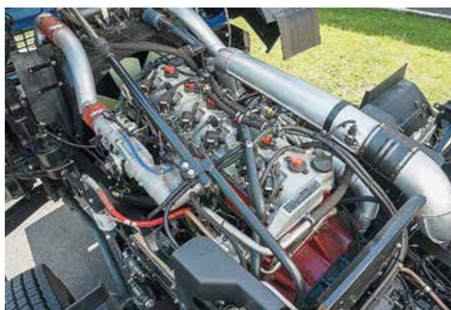
Cummins ISG12G E5 400 – хороший пример того, как внешне выглядит современный газовый двигатель
