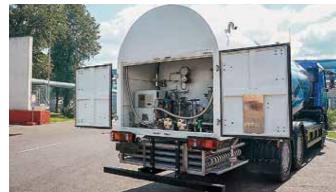
Автотопливозаправщик АПЦЗ-16 для работы с СПГ на шасси MAZ-6501Y8-8525-012
