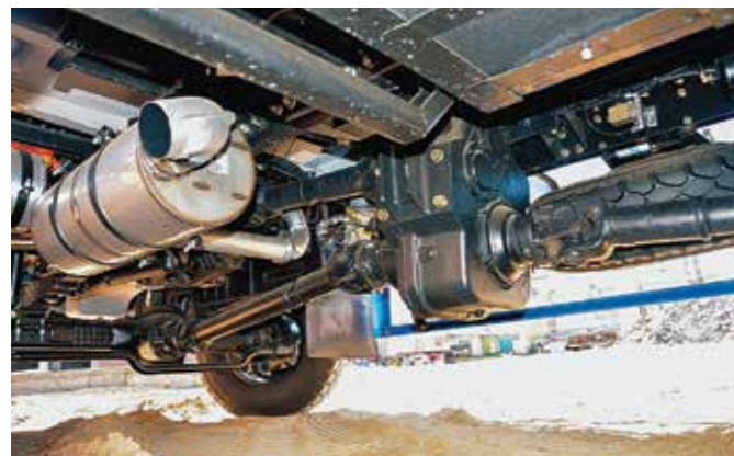
Новое размещение раздаточной коробки позволило сохранить оптимальный угол карданных валов
