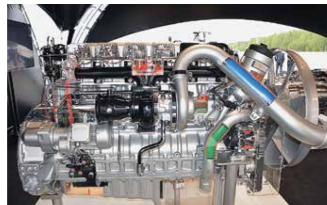
Двигатель OM457LA в частично препарированном виде для демонстрации начинки
