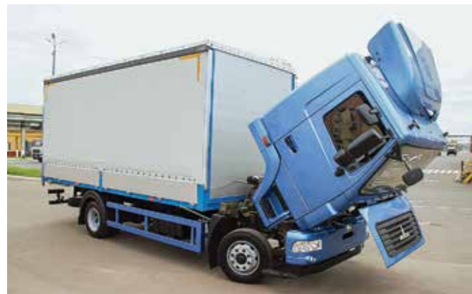
Угол опрокидывания кабины 540 обеспечивает прекрасный доступ для обслуживания двигателя
