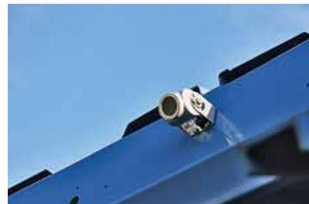
Вверху задней части кузова установлена видеокамера, облегчающая процесс маневрирования
