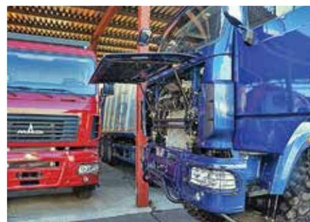
Несмотря на внешнюю схожесть, сверкающий глянцем бампер на полноприводнике полностью металлический!
