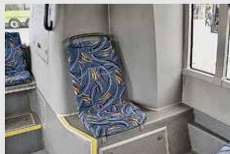
Установка двигателя экологического стандарта Euro-6 в автобусе МАЗ 203988 потребовала увеличения моторного отсека и переконфигурации салона
