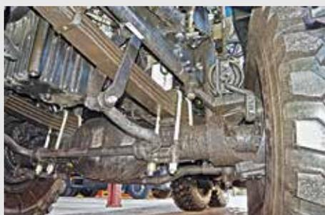
Вот он – новый передний мост во всей красе вместе со стабилизатором. Расстояние от картера до земли – 440 мм
