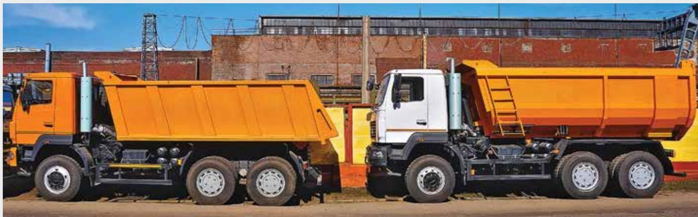
Новая разработка Минского автозавода – строительный самосвал МАЗ-5516W4 с колесной формулой 6х4 и компактной платформой с задней разгрузкой.
