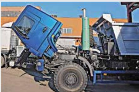
Чтобы добраться до рядной «шестерки» ЯМЗ 652, придется поднять кабину гидравлическим ручным насосом
