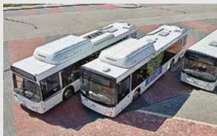
Все газовые баллоны расположены на крыше под унифицированным пластиковым кожухом. Рядом с ним – кондиционер салона
