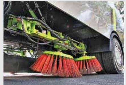
Подметальные щетки оснащены гидроприводом и выкрашены в контрастные цвета
