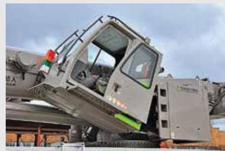
Дверь кабины крановщика сдвижная. Для того, чтобы крановщик мог видеть груз на высоте, кабина сделана подъемной
