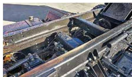
Вместо заклепок теперь масса болтов с самоконтрающимися гайками – в условиях наших перегрузок такое крепление надежнее
