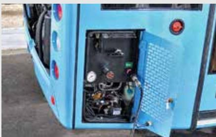
Процесс заправки МАЗ 203965. Открытие крышки – обязательное требование для техники с заправочной горловиной в моторном отделении
