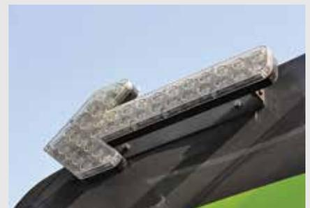
Сверху тыльной части надстройки подметально-уборочной машины установлены габаритные световые индикаторы, выполняющие функцию указателя направления объезда
