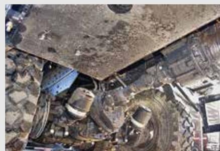
Грузоподъемность задней тележки – 26 000 кг. Сверху видна металлическая защита топливного бака
