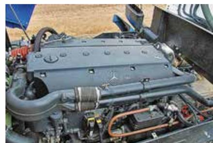
286-сильный турбодизель Mercedes-Benz OM 906, установленный под кабиной
