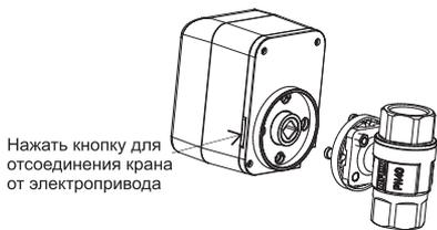
Нажать кнопку для отсоединения крана от электропривода
