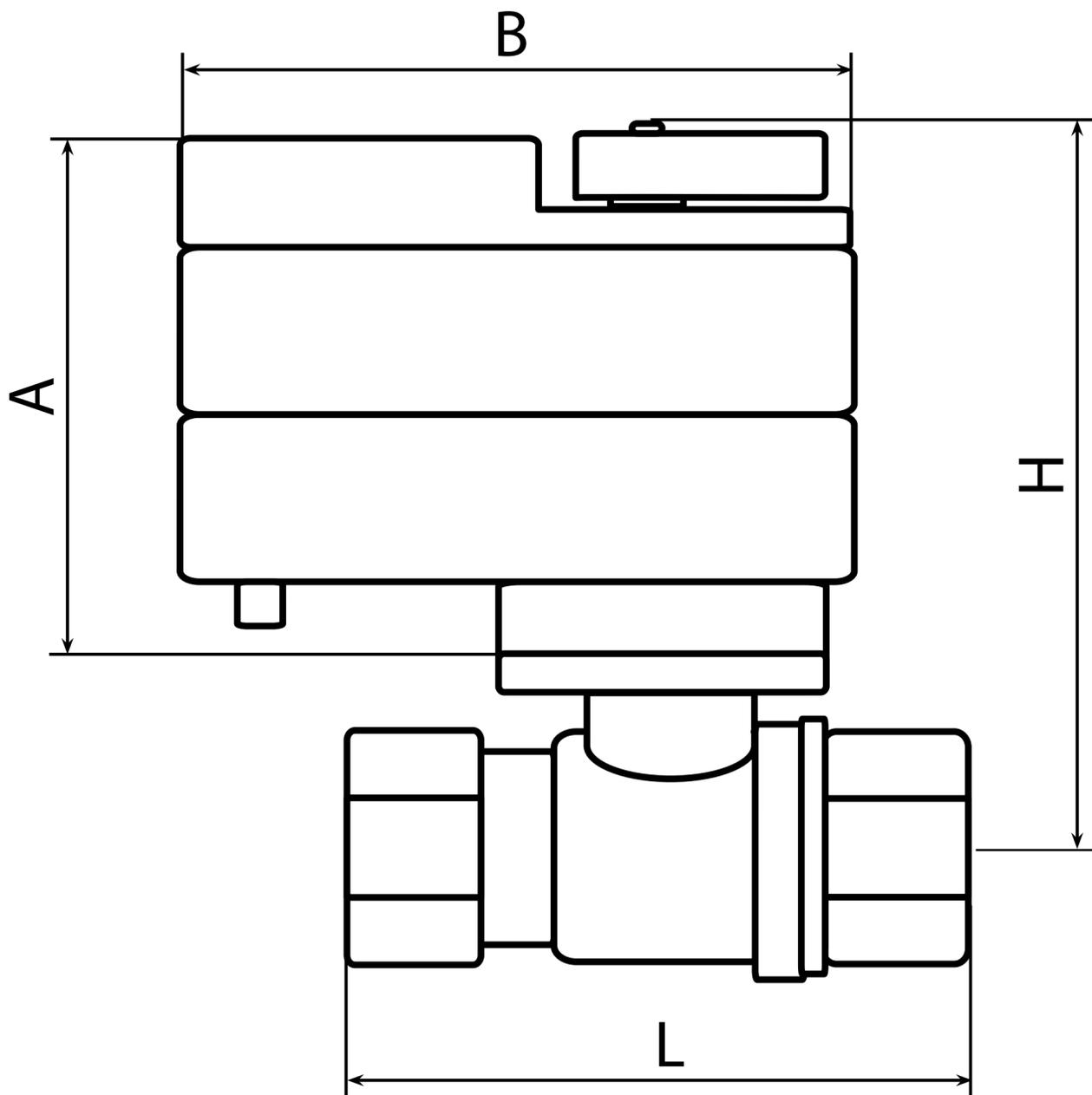
Рис. 3. Характерные размеры шаровых кранов
