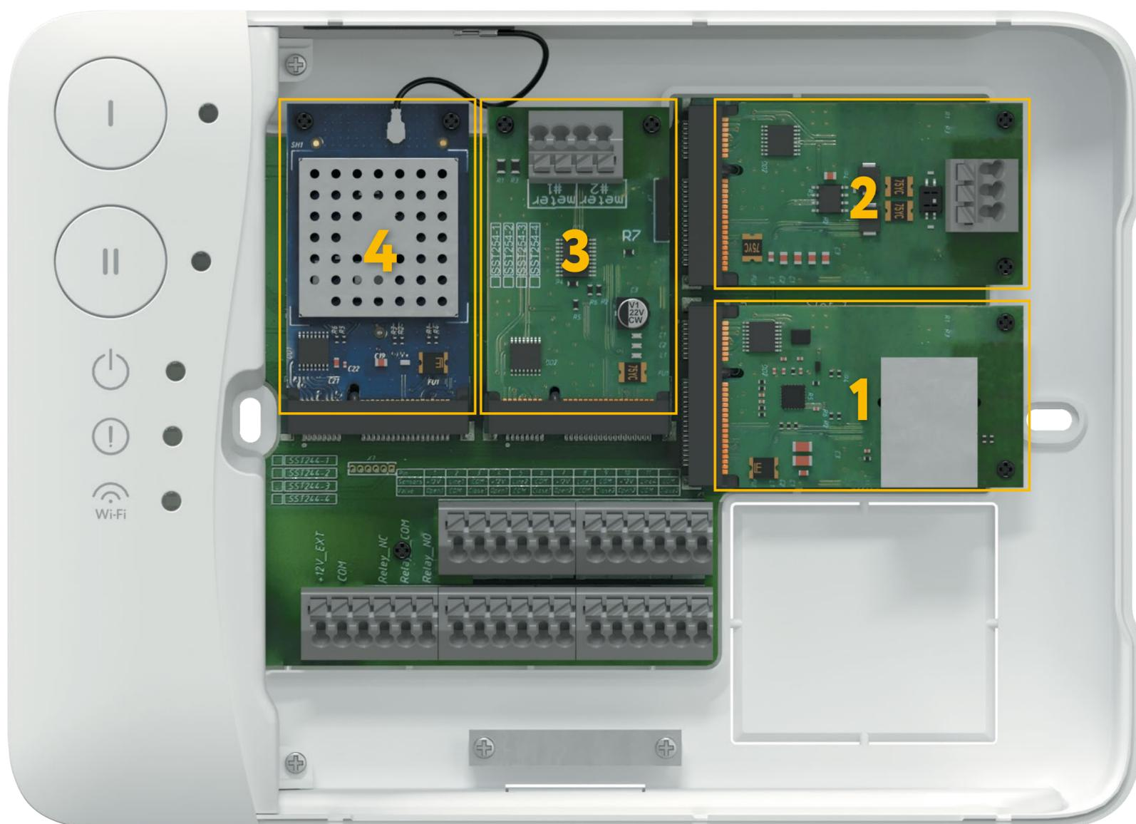
1. Модуль расширения Ethernet
