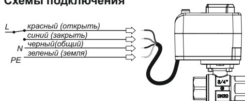
Электрическая схема подключения крана с электроприводом серии Neptun Click SE Bugatti 230 В (рис. 3)
