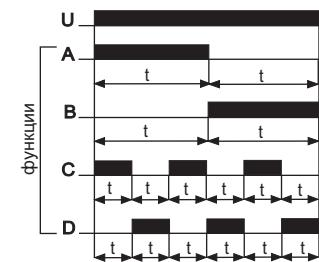
**Включение нагрузки на время  $t$  (A):** после подачи напряжения питания контакты переключаются в положение 11-12, по истечении установленного времени  $t$  контакты возвращаются в положение 10-11.
