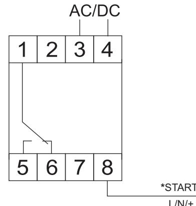
\*При питании реле от постоянного напряжения вход START подключается к "+" источника питания, при переменном напряжении к любому из зажимов 3 или 4.
