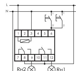
Схема подключения с управлением от нуля "N".
