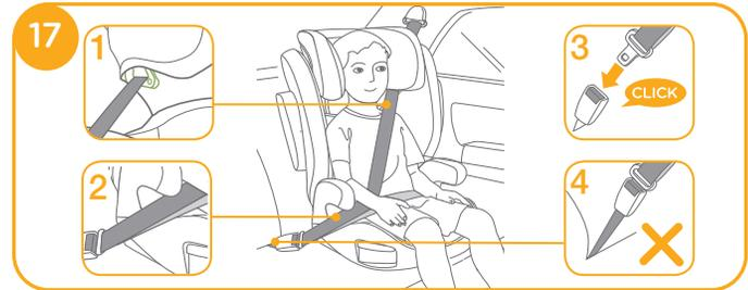
! Kann auch ausschließlich mittels 3-Punkt-Gurt installiert werden. (siehe Abbildungen <sup>17</sup> - <sup>21</sup>)
