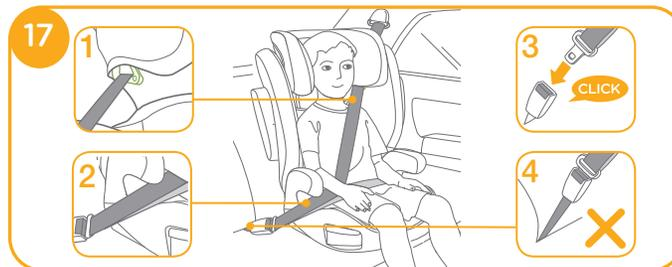
! Può essere installato anche utilizzando solo la cintura a 3 punti di cui sopra. (vedere le figure 17 - 21)
