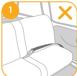
! Ce siège de voiture pour les enfants est adéquat pour des sièges de voiture avec ceintures de sécurité rétractables en 3 points (avec ou sans le support) UNIQUEMENT ②, et avec des points d'ancrage ISOFIX AVEC le support. ③
