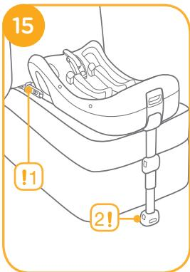
7. Koltuğu çıkarmak için Desteği çıkarmak için 16, önce ikinci kilit açma düğmesine, ardından da desteği araç koltuğundan ayırmadan önce ISOFIX bağlayıcılarındanındaki düğmeye basın. 16 -1 & 16 -2
