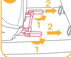
3. Lijn de Isosafe-aansluitingen uit met de ISOFIX-ankerpunten en klik beide Isosafe-aansluitingen in de ISOFIX-ankerpunten. 15
