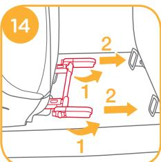
3. Alinhe os conectores ISOFIX com pontos de fixação ISOFIX, e, em seguida, clique nos conectores ISOFIX nos pontos de fixação ISOFIX. <sup>15</sup>
