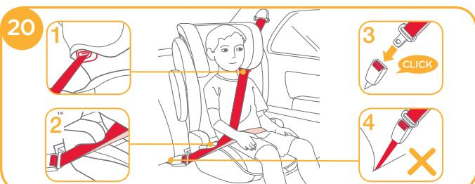
! Kan ook worden geplaatst met alleen de 3-puntsgordel. (zie afbeeldingen 20 - 24)
