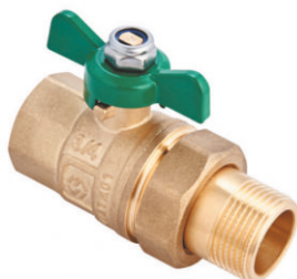
Кран шаровый полнопроходной с полусгоном, резьба внутренняя-наружная, ручка бабочка
