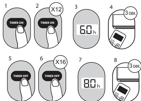
Например: установка таймера на включение через шесть часов работы, рабочее время два часа и затем автоматическое выключение (см. рисунок ниже).
