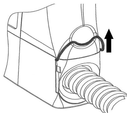
2. Вытащите шланг. Зафиксируйте положение шланга поворотом рычага для фиксации шланга.
