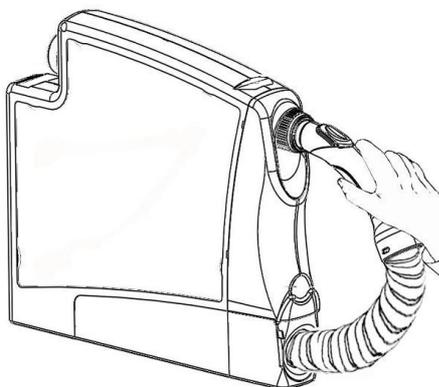
5. Для завершения уборки поднимите рычаг блокировки шланга вверх.
