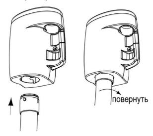
12. Вставьте наконечник в устройство. Установка WallyFlex завершена.
