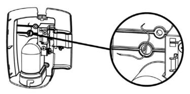
6. Затем прикрепите панель к монтажной рамке, используя три шурупа (#10 длиной ¾ ").
