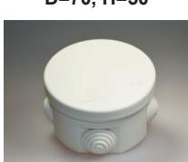
Распаячная коробка изготовлена из полипропилена со вставленными уплотнениями из ПВХ. Провода могут быть установлены через уплотнения 4×20 или уплотнение может быть прорезано ножом в соответствующих местах для ввода труб.
