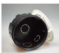
Распаячная коробка для скрытой проводки изготовлена из полипропилена, коробка выполнена в черном цвете, крышка в белом. Имеет 7 вырезных отверстий. Крышка к коробке крепится при помощи пластиковых лапок.
