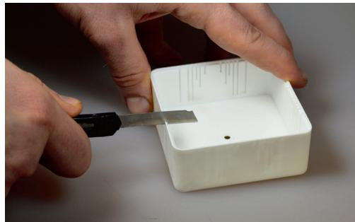
Выполните надрез, под необходимое сечение кабельного канала. Допускается возможность кабель-канала с сечением от 10x7 до 40x25.
