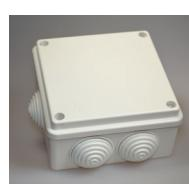
Распаячная коробка изготовлена из полипропилена со вставленными уплотнениями из ПВХ. Между крышкой и коробкой устанавливается АБС уплотнитель из ПВХ, который обеспечивает высокую степень влагозоляции и защиту от попадания пыли. Провода могут быть установлены через уплотнения 6×25 или уплотнение может быть прорезано ножом в соответствующих местах для ввода труб.
