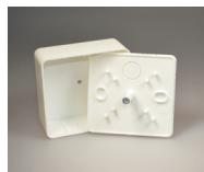
Коробка универсальная для кабель-канала из полистирола выполнена в белом цвете имеет во внутренней части специальные насечки для установки кабель-канала. Крепление крышки к основанию осуществляется при помощи самореза. Внутренние размеры: 75x75x30.
