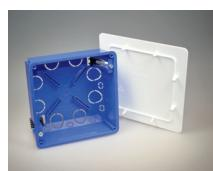
Распаячная коробка для скрытой проводки изготовлена из полипропилена, коробка выполнена в синем цвете, крышка в белом. Имеет 20 вырезных отверстий. Крышка к коробке крепится при помощи пластиковых лапок. Коробка устанавливается в гипсокартонные и пустые стены и закрепляется при помощи имеющихся пластиковых лапок.
