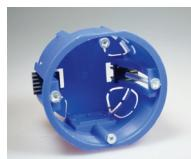
Коробка установочная ГСК изготовлена из полипропилена, коробка выполнена в синем цвете. Имеет 4 вырезных отверстия. Коробка устанавливается в гипсокартонные и полые стены и закрепляется при помощи имеющихся пластиковых лапок.
