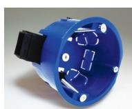
Коробка установочная ГСК изготовлена из полипропилена, коробка выполнена в синем цвете. Имеет 4 вырезных отверстия. Коробка устанавливается в гипсокартонные и полые стены и закрепляется при помощи имеющихся пластиковых лапок. Коробка комплектуется с переходником 80-0010.
