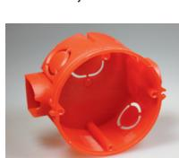
Установочная коробка изготовлена из полипропилена, коробка выполнена в красном цвете. Имеет 7 вырезных отверстий. Устанавливается в сплошные и полые стены, для последующего закрепления в ней выключателей, розеток и другого электрооборудования. Коробка комплектуется двумя саморезами.
