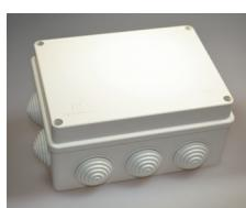
Распаячная коробка изготовлена из полипропилена со вставленными уплотнениями из ПВХ. Между крышкой и коробкой устанавливается АБС уплотнитель из ПВХ, который обеспечивает высокую степень влагоизоляции и защиту от попадания пыли. Провода могут быть установлены через уплотнения 10×25 или уплотнение может быть прорезано ножом в соответствующих местах для ввода труб.
