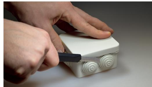
Перед установкой трубы «Промрукав» в гермовводах распаячной коробки необходимо выполнить срез на гермоводе, под соответствующий диаметр устанавливаемой трубы.
