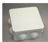
Распаячная коробка изготовлена из полипропилена со вставленными уплотнениями из ПВХ. Провода могут быть установлены через уплотнения 7×20 или уплотнение может быть прорезано ножом в соответствующих местах для ввода труб.
