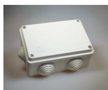
Распаячная коробка изготовлена из полипропилена со вставленными уплотнениями из ПВХ. Между крышкой и коробкой устанавливается АБС уплотнитель из ПВХ, который обеспечивает высокую степень влагоизоляции и защиту от попадания пыли. Провода могут быть установлены через уплотнения 6×25 или уплотнение может быть прорезано ножом в соответствующих местах для ввода труб.
