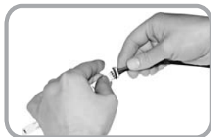
Шаг 2. Вставить ленту в разъем соединителя.
