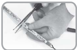
Шаг 1. Разрезать ленту по линии реза.
