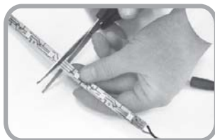
Шаг 1. Разрезать ленту по линии реза.
