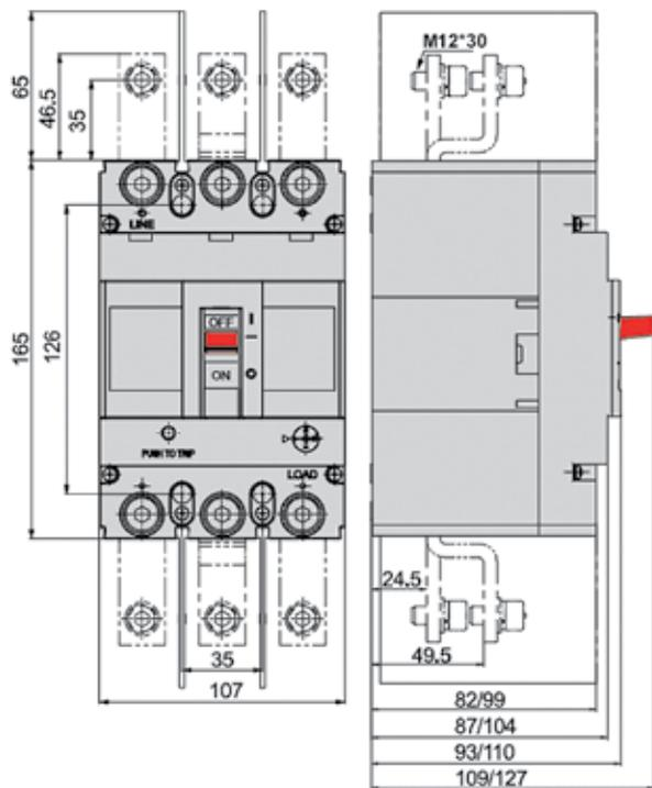
Шаблон для разметки монтажной панели
