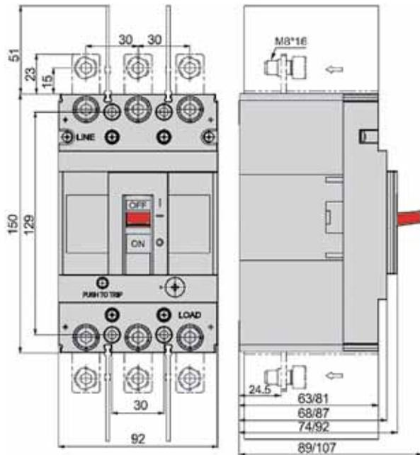
Шаблон для разметки монтажной панели
