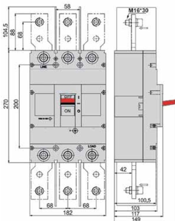
Шаблон для разметки монтажной панели
