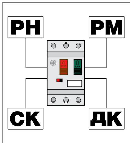
Расцепители независимые серии РН-400, расцепители минимального напряжения серии РМ-400, дополнительные контакты серии ДК-400, контакты сигнальные серии СК-400.
