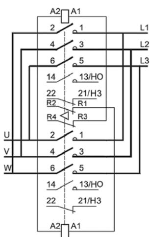
КМ-103 9-95А (горизонтальное подключение, механическая + электрическая блокировка)
