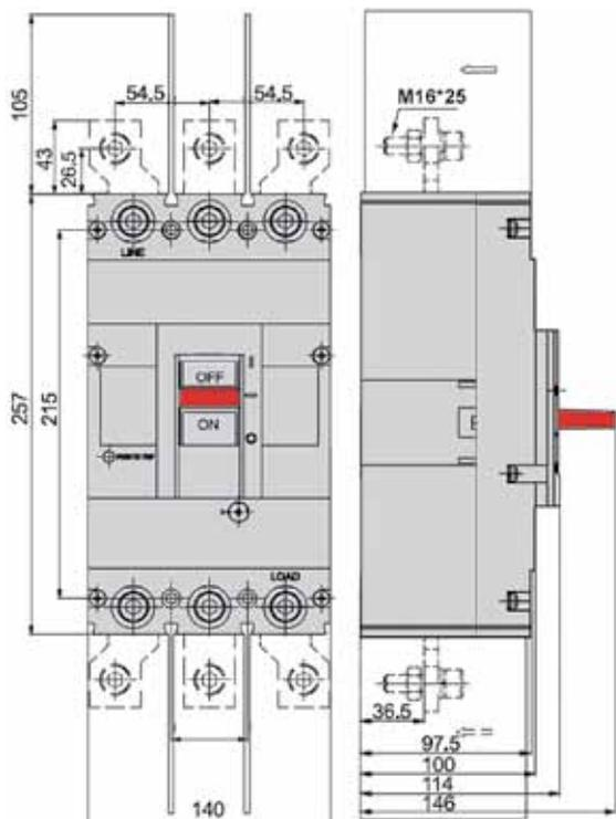
Шаблон для разметки монтажной панели
