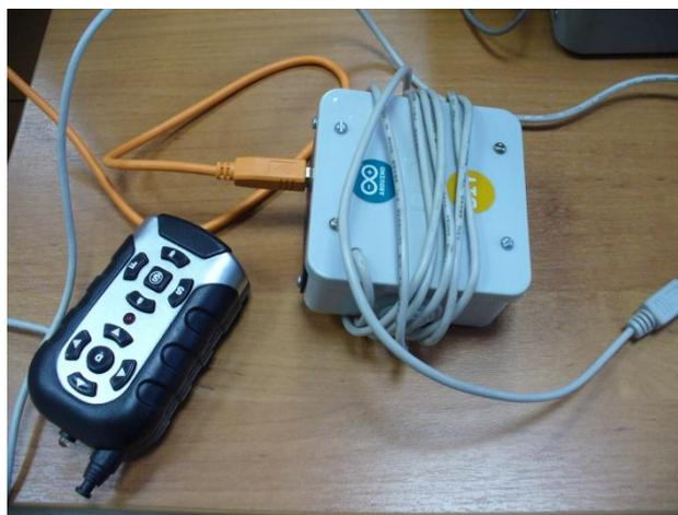
Рис. 18. Плата Arduino с блоком реле в корпусе и пульт с кабелем
