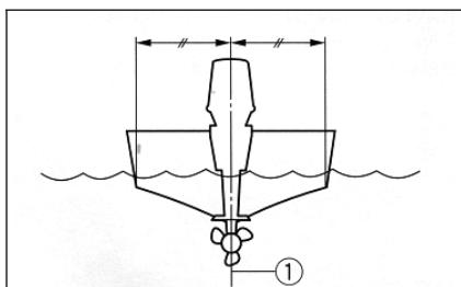
Устанавливайте мотор по центральной (килевой) линии лодки. Убедитесь, что сама лодка хорошо сбалансирована. В противном случае лодкой будет трудно управлять. По поводу бескилевых или асимметричных лодок посоветуйтесь с дилером "SEA-PRO".
