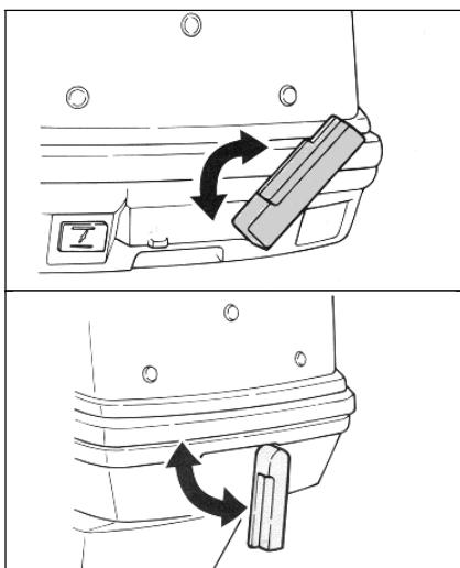
Чтобы снять верхний кожух двигателя, поднимите переднюю стопорную защёлку кожуха и опустите заднюю стопорную защёлку (защёлки), затем снимите кожух. Когда будете ставить кожух на место, убедитесь, что он плотно сел в резиновое уплотнение. После этого установите кожух на место, зафиксировав стопорные защёлки в закрытом положении.
