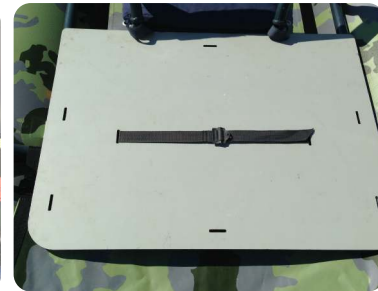
Крепление жесткого багажника. Сверху затянуть через пряжку. Используется ремень, которым затягивается сложенный катамаран.
