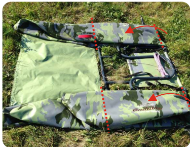
8. Сложите концы баллонов по длине. Пунктиром указаны места сгибов. Сначала передние концы без клапана.
