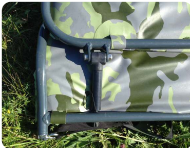
9. Сложите второе крыло. Заправьте уключину под основание крыла. Надавите на крыло, чтобы выпустить воздух из баллонов.
