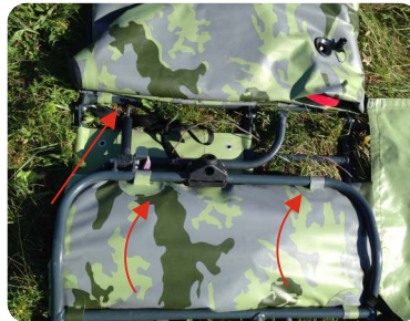
8. Сложите первое крыло. Уключину заправить под основание второго крыла. Не складывайте уключину в другую сторону и не давите. Прогнете трубу и выломаете шток уключины.
