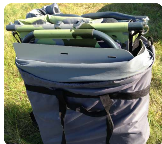
9. Сложите второе крыло. Заправьте уключину под основание крыла. Надавите на крыло, чтобы выпустить воздух из баллонов.
