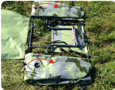
8. Сложите концы баллонов по длине. Пунктиром указаны места сгибов. Сначала передние концы без клапана.
