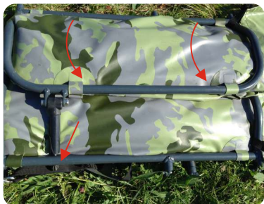
9. Сложите второе крыло. Заправьте уключину под основание крыла. Надавите на крыло, чтобы выпустить воздух из баллонов.
