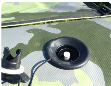
Белый клапан нажат вниз - открыт вверх - закрыт
