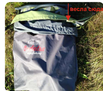
9. Сложите второе крыло. Заправьте уключину под основание крыла. Надавите на крыло, чтобы выпустить воздух из баллонов.
