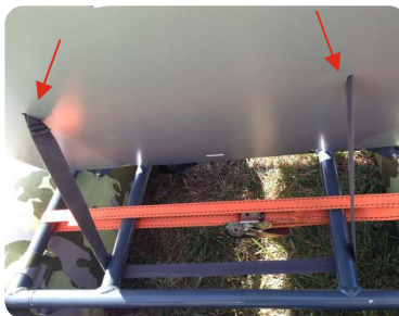
Крепление жесткого багажника. Сверху затянуть через пряжку. Используется ремень, которым затягивается сложенный катамаран.
