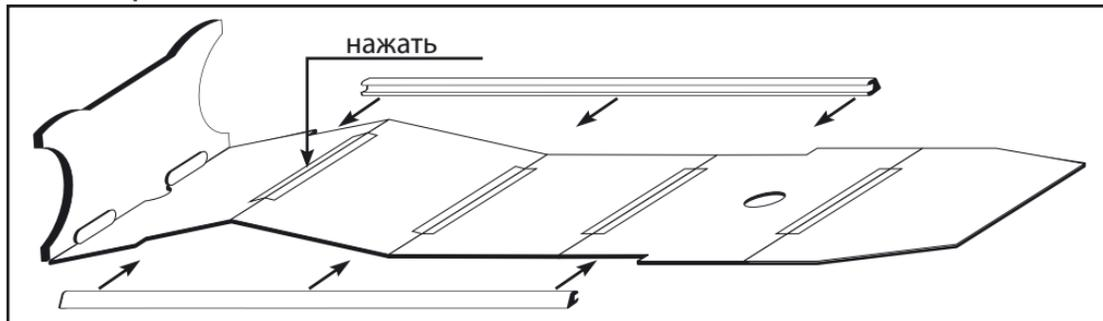
4.7. Докачайте два основных прямых баллона до давления 0,2 атм. Это, примерно, соответствует прогибу оболочки баллона в 5 мм, при легком нажатии на него ладонью руки. Затем накачайте носовой баллон.
