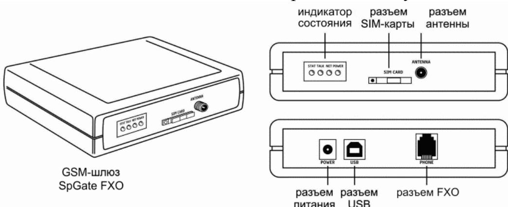
Рисунок 2.1. GSM-шлюз SpGate FXO
