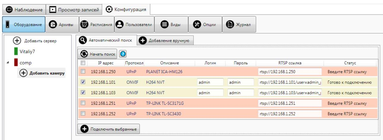
Рисунок 12: Автоматическое добавление камер
