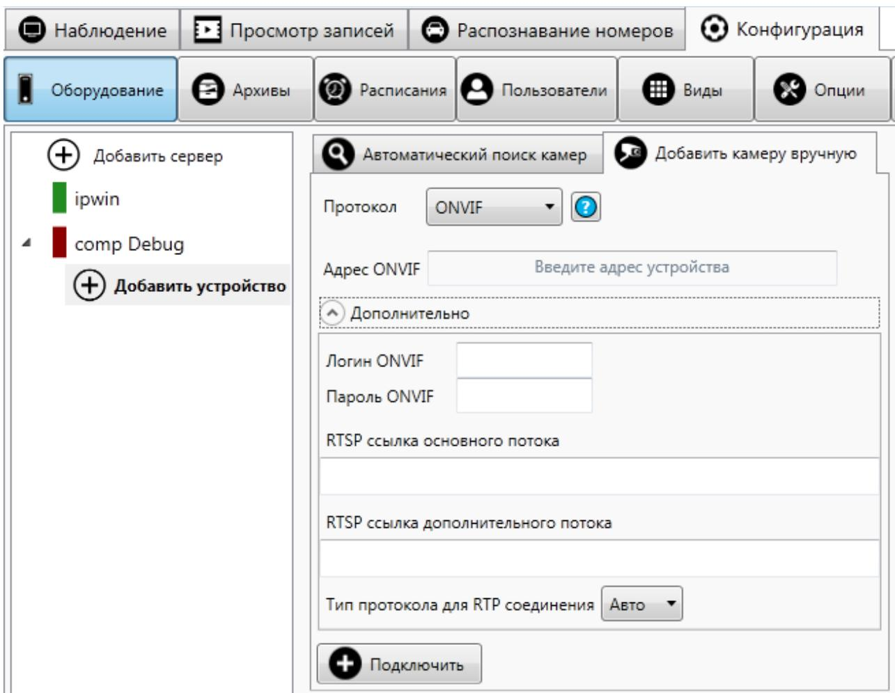
Рисунок 13: Подключение камеры по протоколу Onvif
