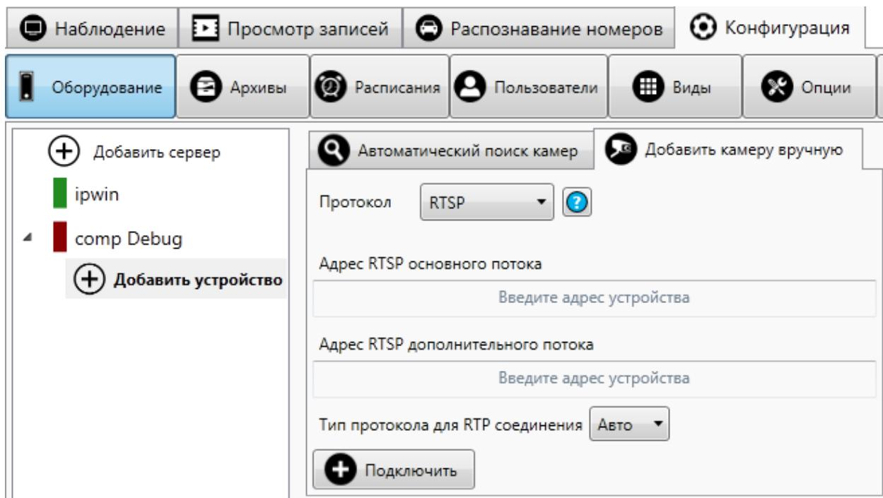
Рисунок 14: Подключение камеры по протоколу RTSP
