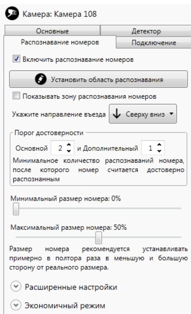
Рисунок 49: Настройка распознавания номеров
