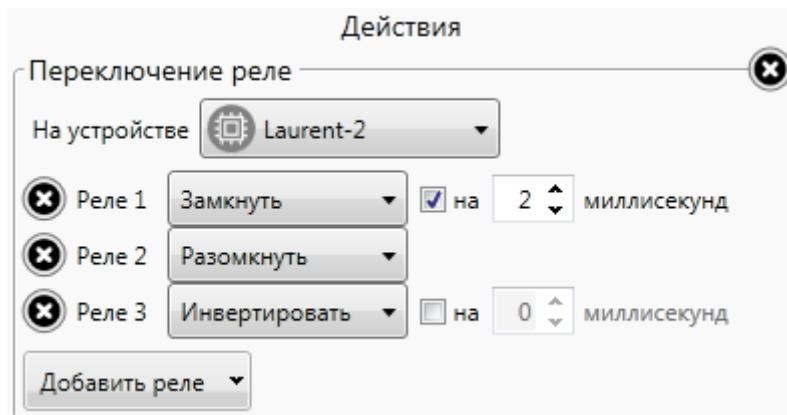
Рисунок 72: Действие переключение реле
