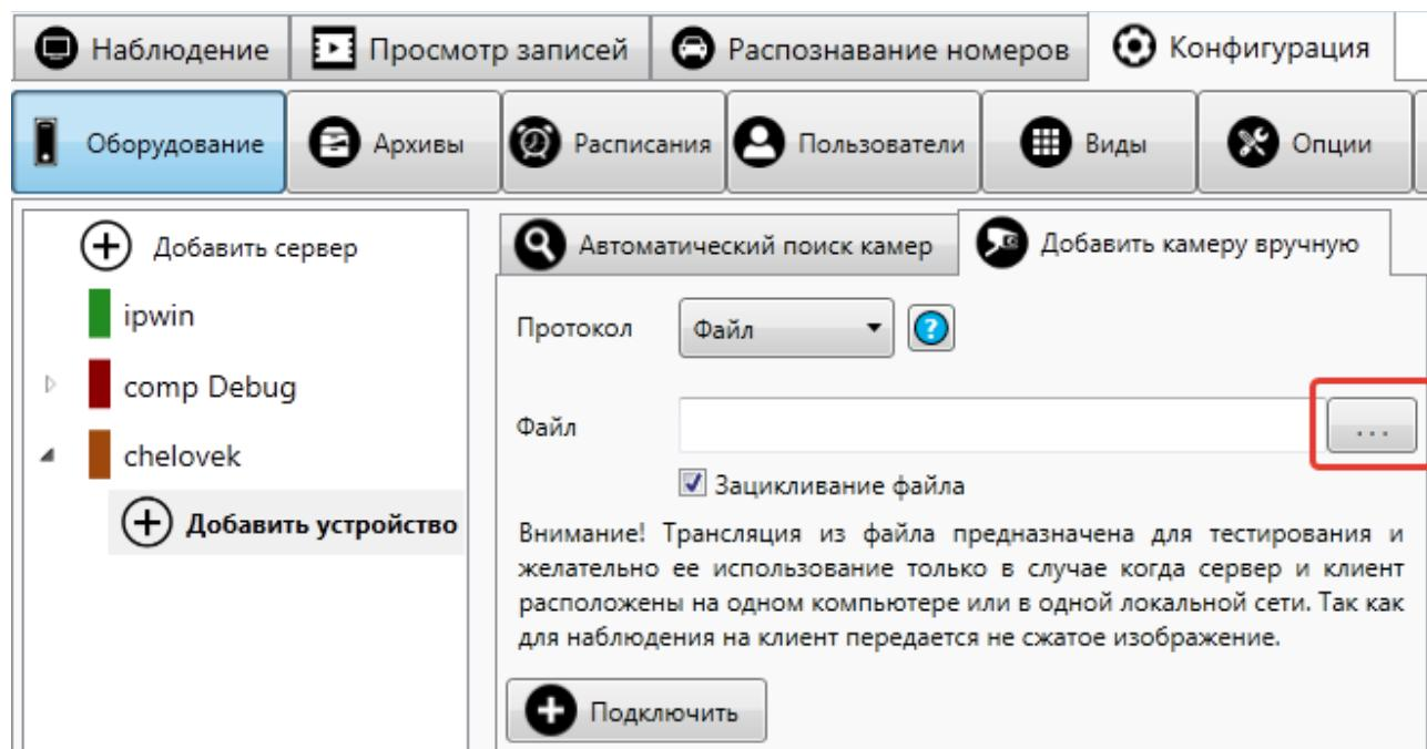
Рисунок 41: Подключение видео файла
