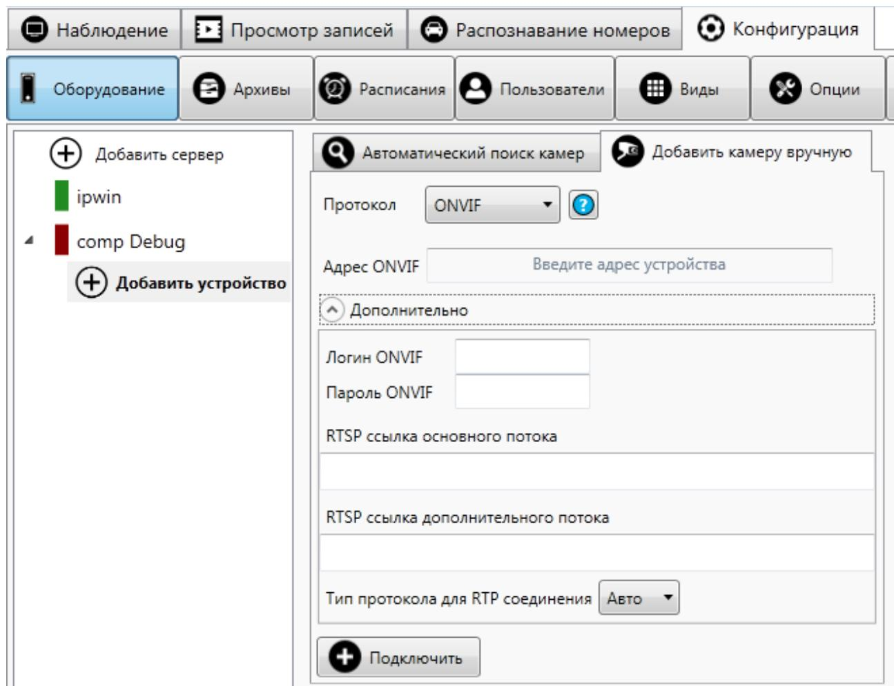
Рисунок 39: Подключение камеры по протоколу Onvif
