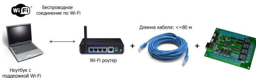
Рис. Схема беспроводного подключения компьютер – модуль с использованием WiFi роутера
