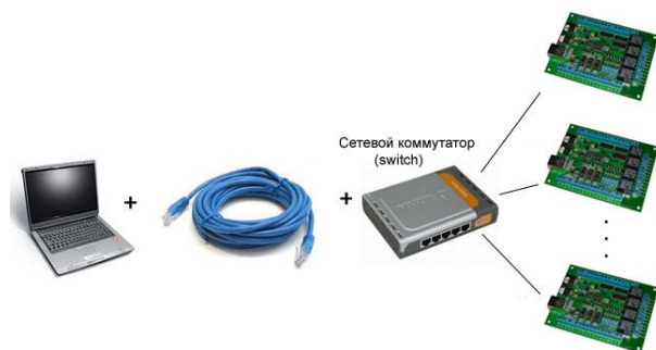
Рис. Схема подключения нескольких модулей к одной сети с использованием switch
