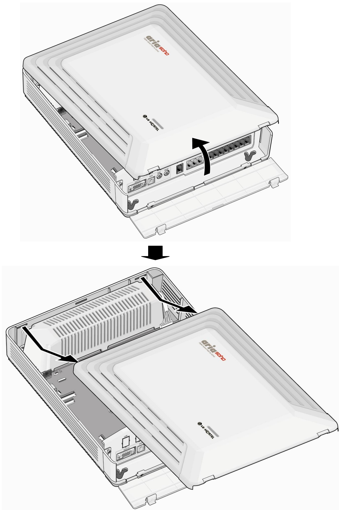
Рис. 3.2.3.1 Снятие лицевой панели
