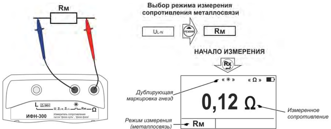
Рисунок 2.7 - Измерение сопротивления металlosвязи
