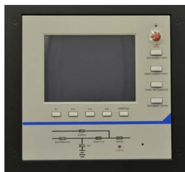
Широкий ЖК-дисплей с мнемосхемой
