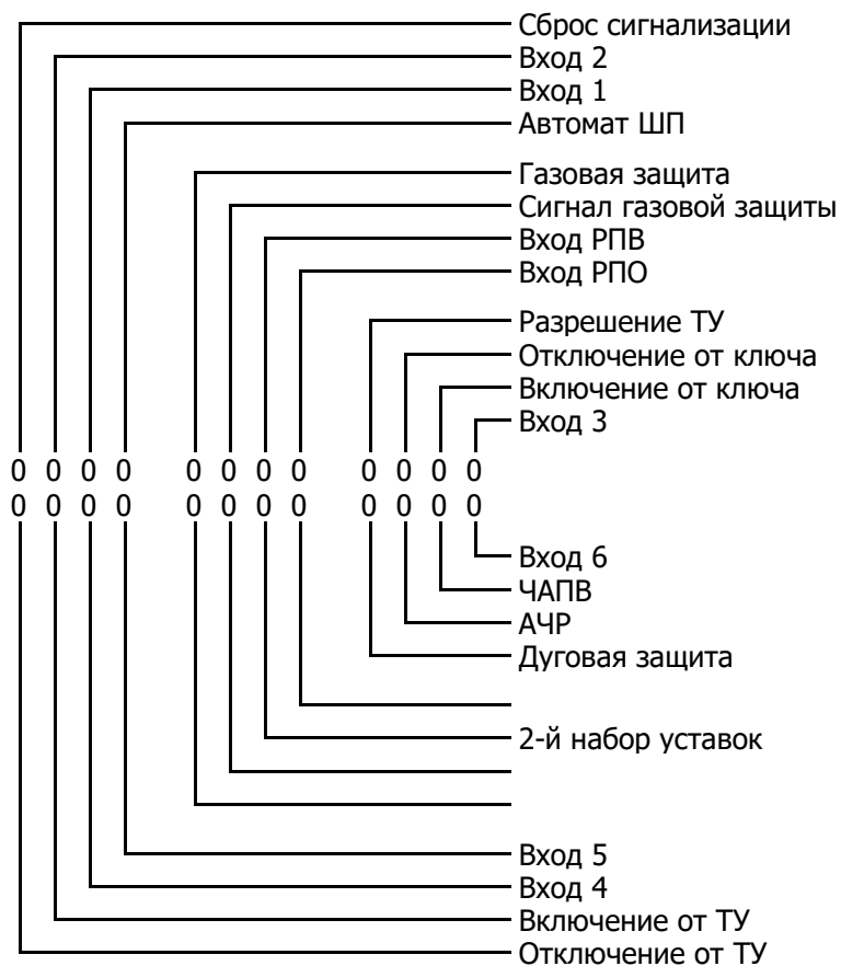
Рисунок В.1 – Соответствие входных дискретных сигналов в режиме «Контроль входов». Наличие сигнала на входе соответствует «1», отсутствию – «0».
