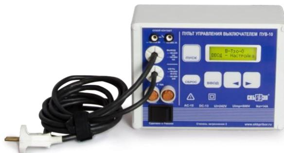
**Пульт управления приводами выключателей постоянного и переменного тока.** ПУВ-10 применяется при проведении испытаний высоковольтных выключателей при контроле их технического состояния до, после и во время ремонта. Пульт предназначен для формирования команд управления выключателей путем автоматической подачи на катушки электромагнитов электрического напряжения постоянного или переменного тока.
