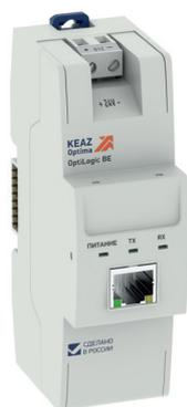
Модуль расширения шины BE-1 предназначен для подключения удаленных модулей ввода/вывода к шине расширения CPU или подключения модулей ввода/вывода к любым ПЛК по интерфейсу RS-485 с протоколом Modbus RTU.
