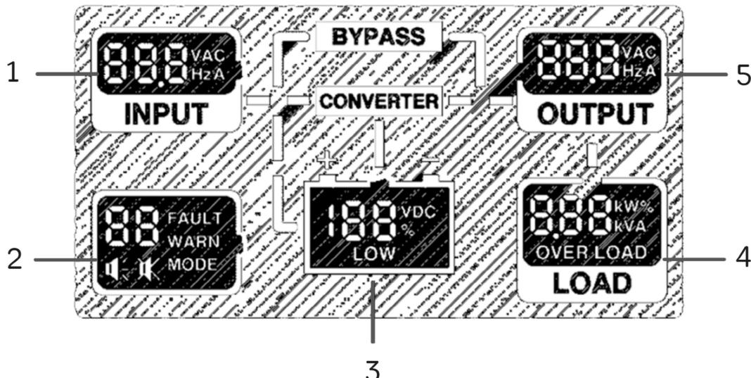
Рис. 5-2 LCD дисплей
