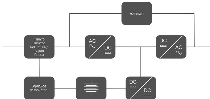
Рис. 3-1 Структурная схема ИБП
