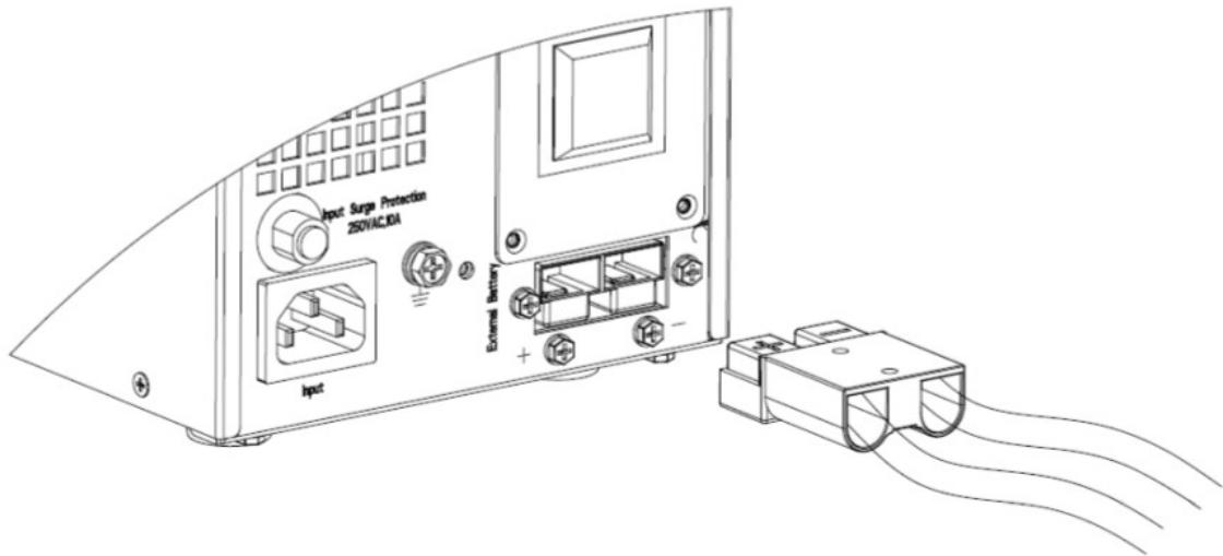
Рис. 4-1 Подключение АКБ
