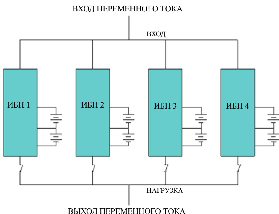
Убедитесь в том, что выключатели ИБП разомкнуты, а на выходе соединенных ИБП нет выходного напряжения. Допускается отдельное и параллельное соединение аккумуляторных групп, то есть в качестве отдельного и общего аккумуляторного блока.
