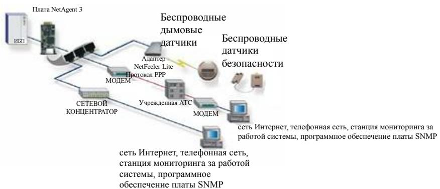
Стандартная топология сетевого управления ИБП.
