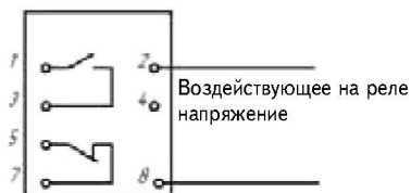
Рисунок 3 — Схема электрическая подключения реле PH 53, PH 54.
