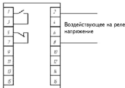
Рисунок 4 — Схема электрическая подключения реле PH 153, PH 154.
