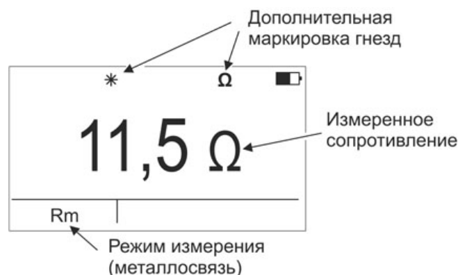
Рисунок 2.4.3.2 - Измерения сопротивления металlosвязи
