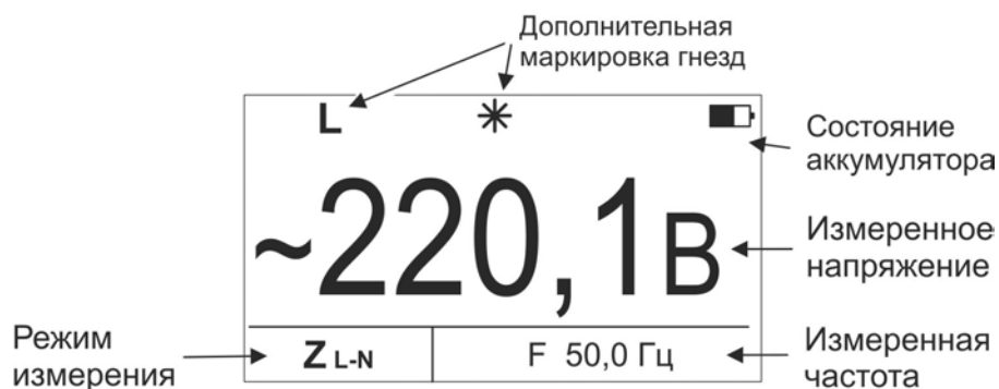
Рисунок 2.4.1 - Измерение напряжения и частоты
