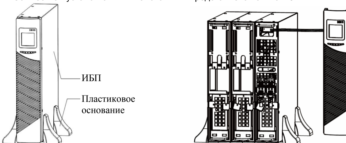
Рис.16 Установка ИБП и внешних аккумуляторных блоков
