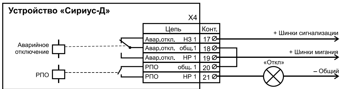
Рисунок Д.4 – Вариант реализации схемы с миганием сигнальной лампочки аварийного отключения устройства с использованием общеподстанционной схемы сигнализации
