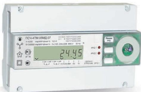
Счетчики предназначены для измерения и учета активной и реактивной энергии (в том числе и с учетом потерь), ведения массивов профиля мощности нагрузки с программируемым временем интегрирования (в том числе и с учетом потерь), фиксации максимумов мощности, измерения параметров трехфазной сети и параметров качества электрической энергии.
