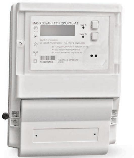
Счетчики предназначены для учета активной и реактивной энергии прямого и обратного направлений в трехпроводных и четырехпроводных сетях переменного тока частотой 50 Гц и могут использоваться автономно или в составе АИИС КУЭ.
