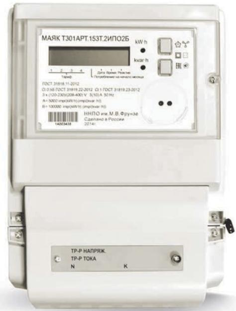
Счетчики предназначены для учета активной и реактивной энергии прямого и обратного направления в трехпроводных и четырехпроводных сетях переменного тока частотой 50 Гц, дифференцированного как по времени суток, так и по уровню потребляемой электроэнергии и мощности.
