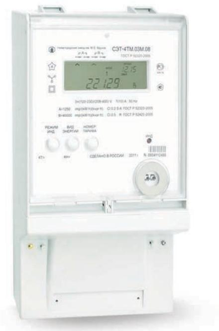
Счетчики предназначены для измерения и учета активной и реактивной энергии (в том числе и с учетом потерь), ведения массивов профиля мощности нагрузки с программируемым временем интегрирования (в том числе и с учетом потерь), фиксации максимумов мощности, измерения параметров трехфазной сети и параметров качества электрической энергии.
