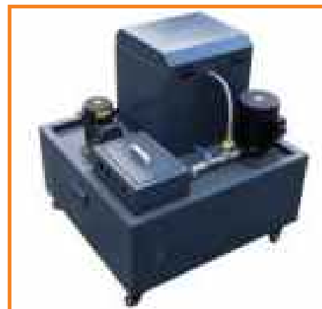
Два мотора поднятия давления СОЖ
