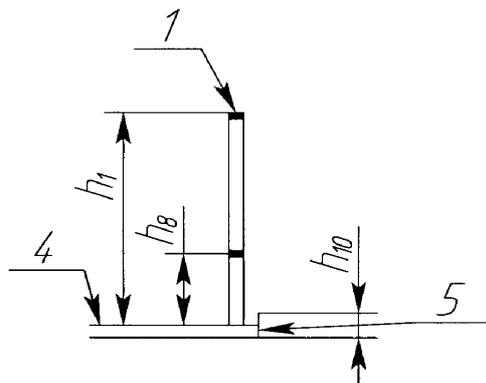
с) Вход на нижнюю посадочную площадку, предохранительная заслонка для платформ с перемещением до 500 мм
