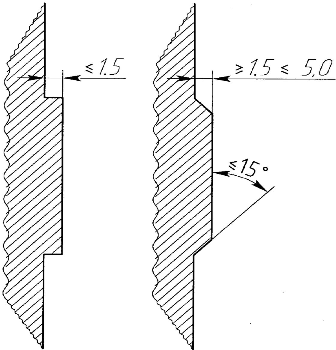
Рисунок 11 – Размеры допустимых выступов в зонах перемещения
