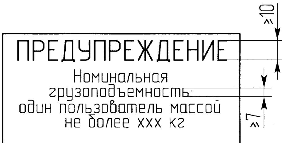
Рисунок 15 - Образец стандартной надписи с информацией о грузоподъемности
