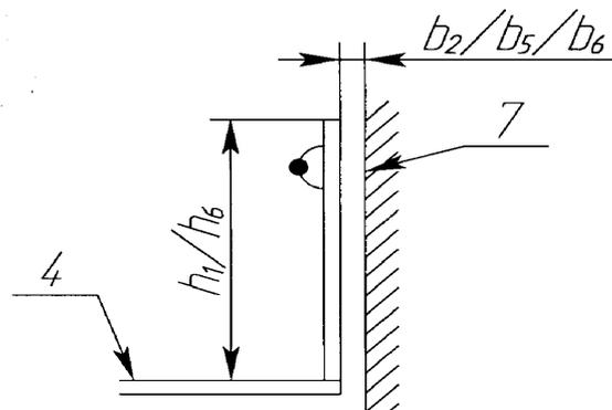
д) Ограничение доступа к краям платформы; предохранительный неперфорированный барьер для платформы с перемещением более 2000 мм, использование барьера в качестве поручня
