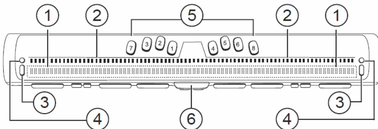
Обновляемые ячейки Брайля (1) расположены на передней панели устройства. Над каждой брайлевской ячейкой находится кнопка перемещения курсора (2). На каждом конце поверхности дисплея расположены NAV Rockers (навигационные клавиши-качельки)(3), используемые для более удобной навигации. Над каждой клавишей NAV Rocker расположены кнопки переключения режимов навигации (4).
