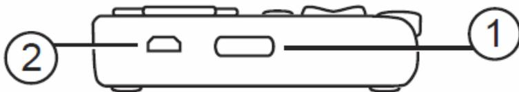
С левой стороны дисплея, следуя от передней панели к задней, вы найдёте кнопку Power (Питание) (1), стандартный микро USB-порт (2). USB-порт позволяет подключать дисплей к компьютеру при помощи поставляемого в комплекте USB-кабеля или к адаптеру питания.
