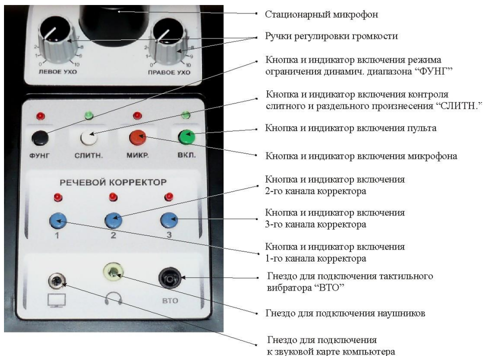
Рисунок 1. Пульт ученика «УНИТОН АК-ПУ». Органы управления и коммутации.
