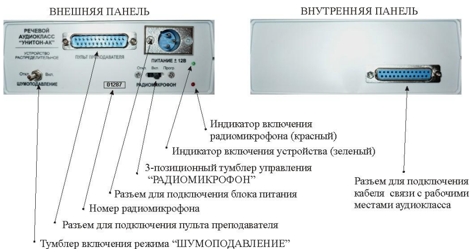
Рисунок 4. Устройство распределительное «УНИТОНАК-УР». Органы управления и коммутации.
