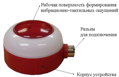
Рисунок 2. Тактильный вибратор (устройство формирования вибрационно-тактильных ощущений) «УНИТОН-ВТО»
