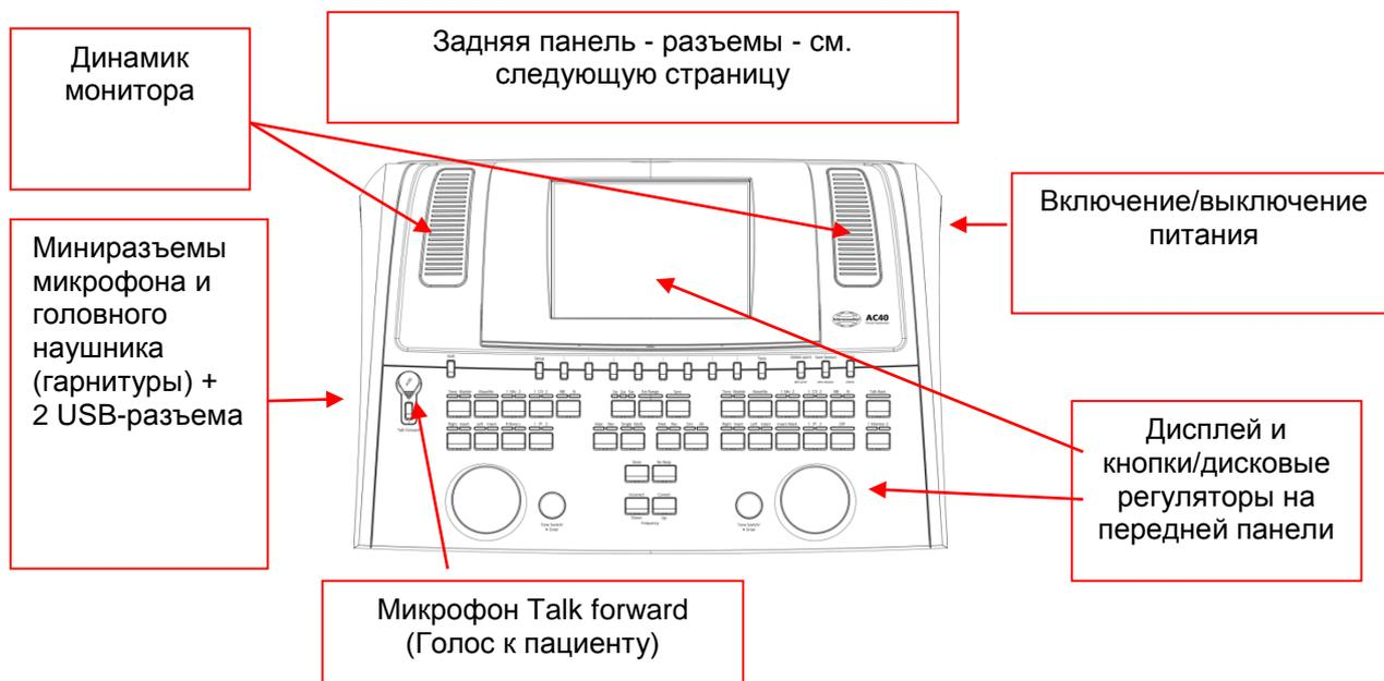
В верхнем левом углу AC40 (обойма дисплея) находится динамик монитора.
