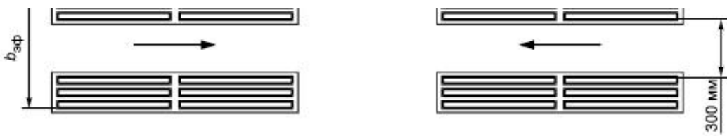
Рисунок А.6 - Форма рифления - прямолинейные параллельные рифы с плоской вершиной (6 шт.), используемые для обустройства направляющего указателя для движения в одном направлении
