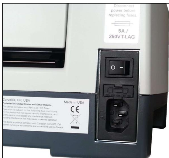
Показан модуль питания на задней стороне принтера
