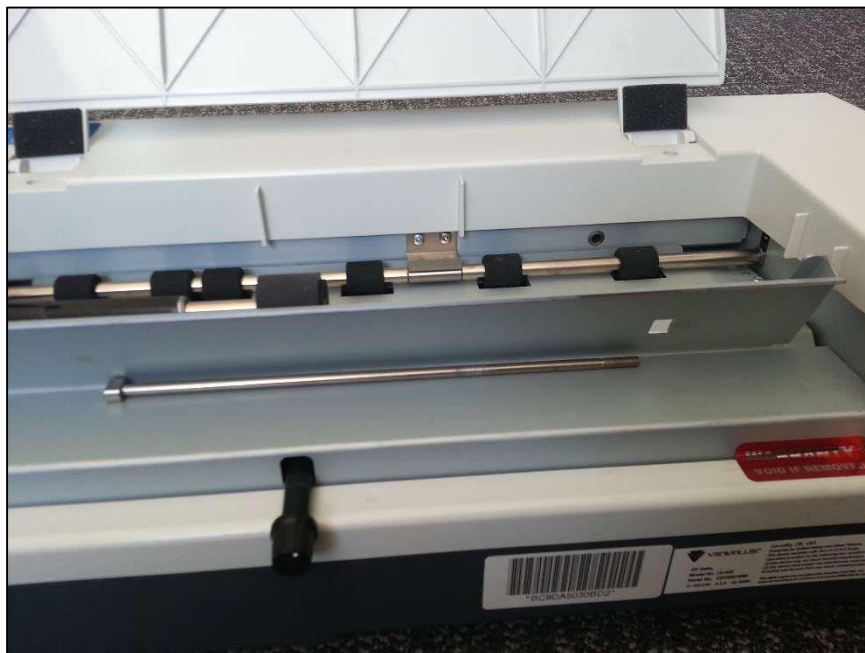
Показано предложенное место хранения блокировочного стержня
